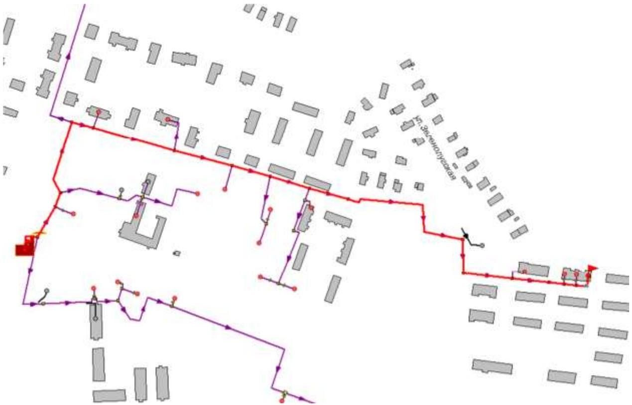
**Рисунок 3.1 -Расчетный путь теплоносителя котельной до КЛДК 23, УУ1**
