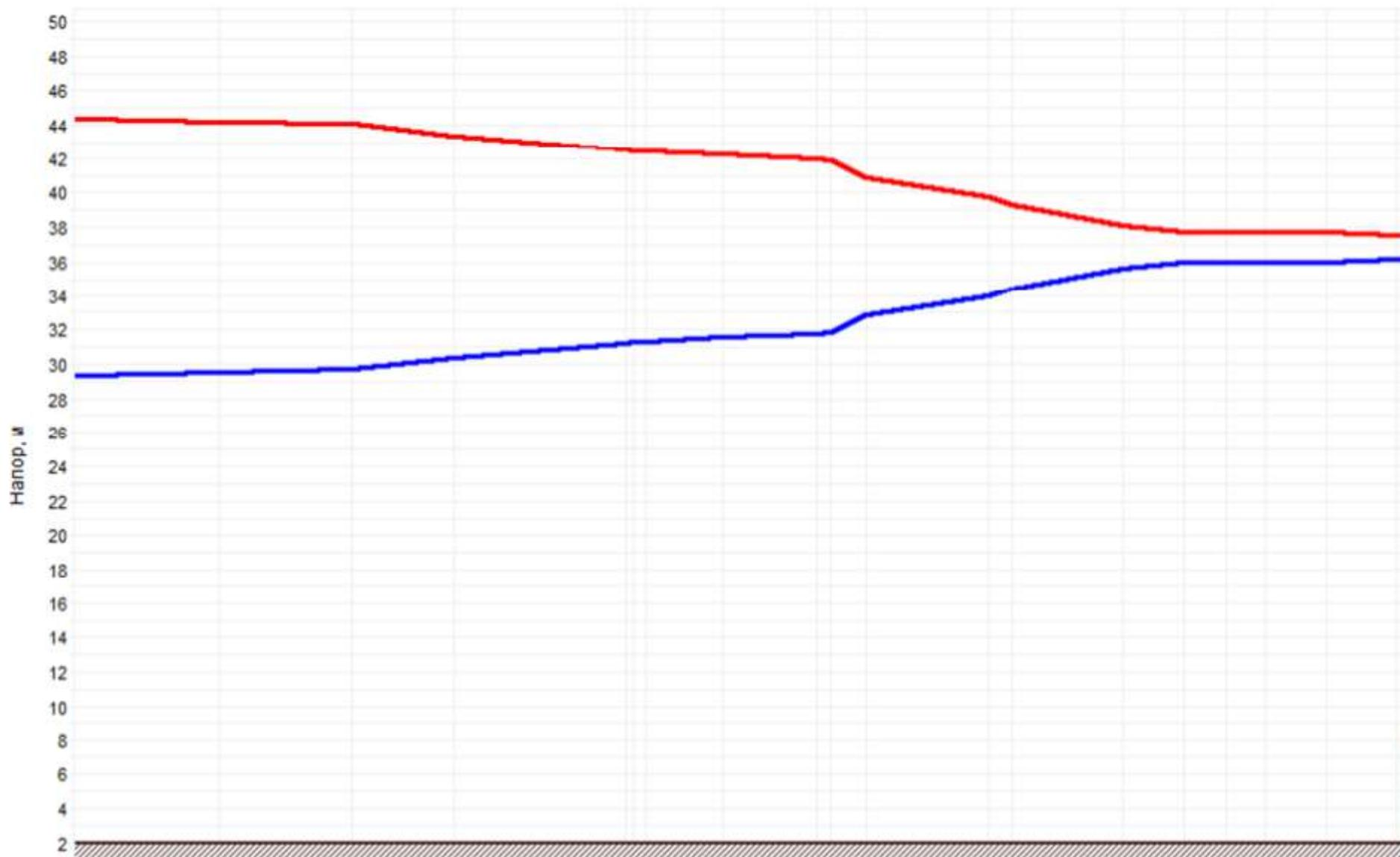
Рисунок 33.2 –График гидравлических режимов рассматриваемого теплопровода
