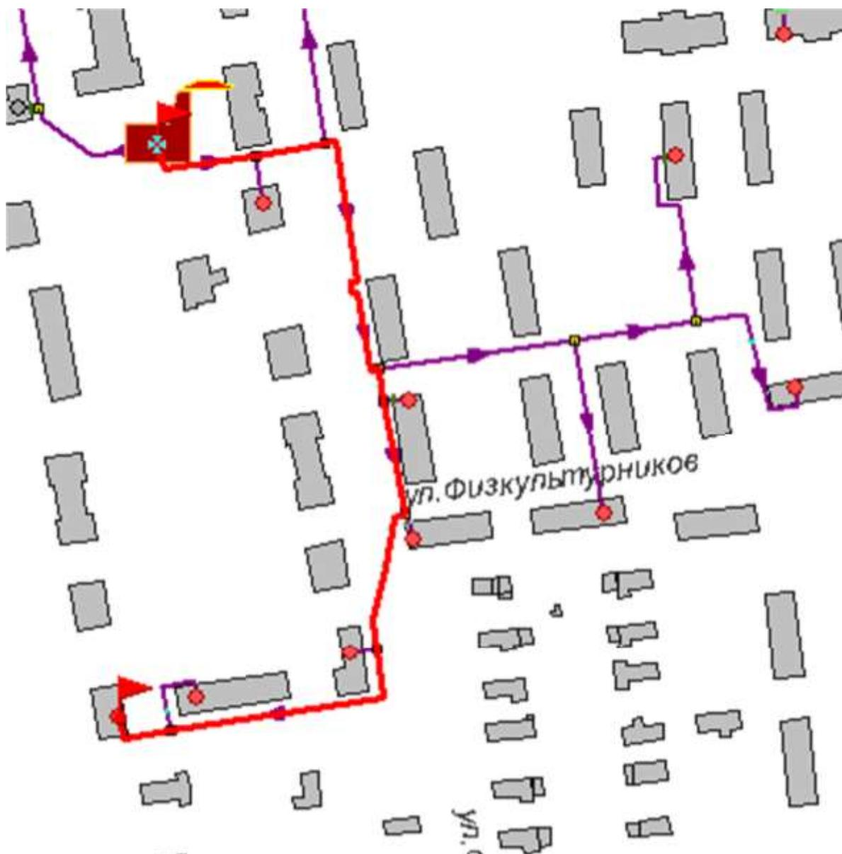
**Рисунок 28.3 -Расчетный путь теплоносителя от котельной до Маслова,23 к.1**
