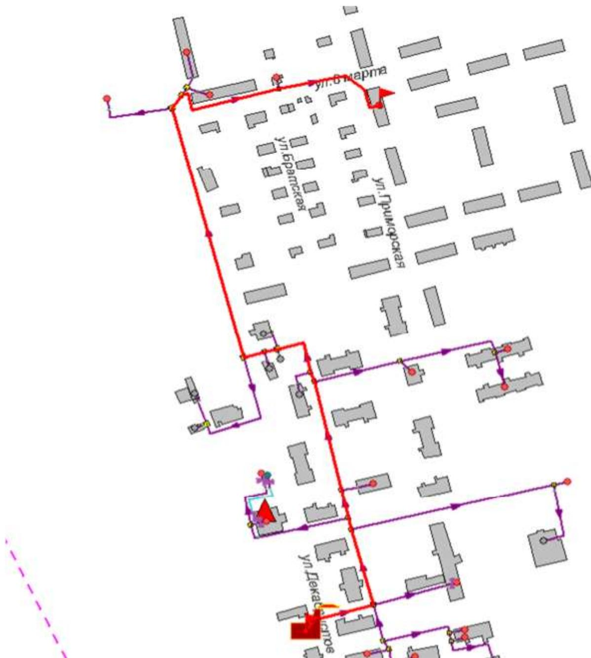
**Рисунок 24.3 -Расчетный путь теплоносителя от котельной до Приморская,16**
