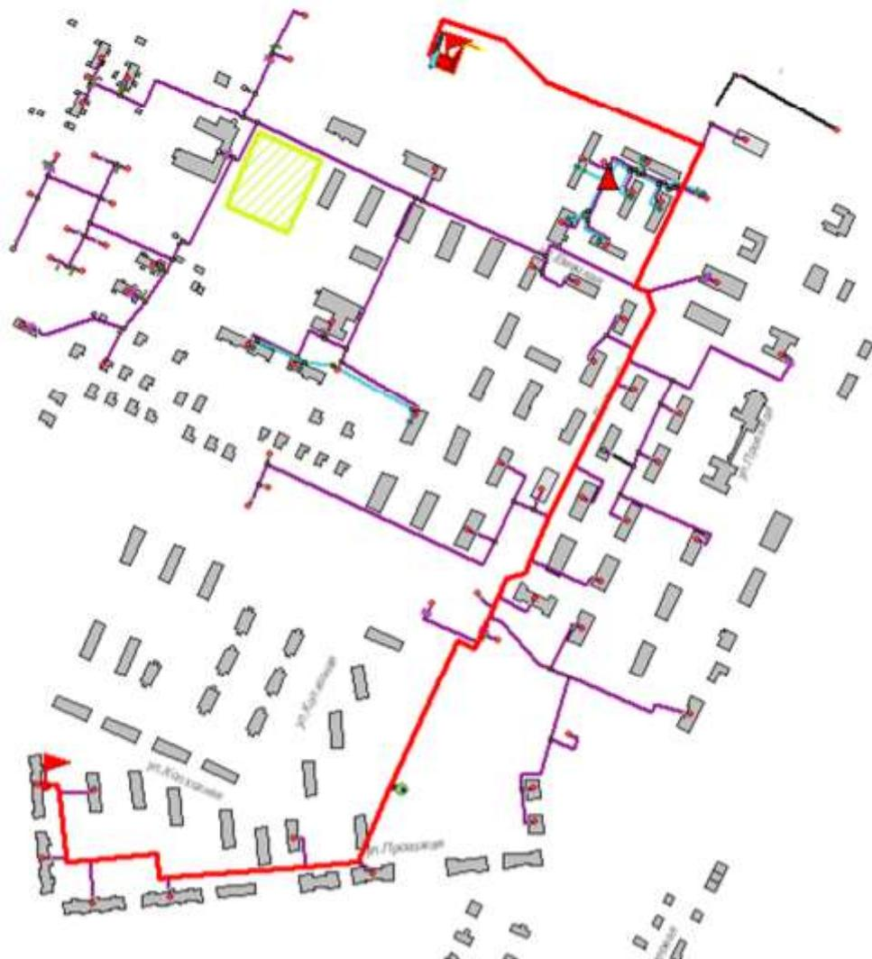
**Рисунок 27.1 -Расчетный путь теплоносителя котельной до Колхозная,35**
