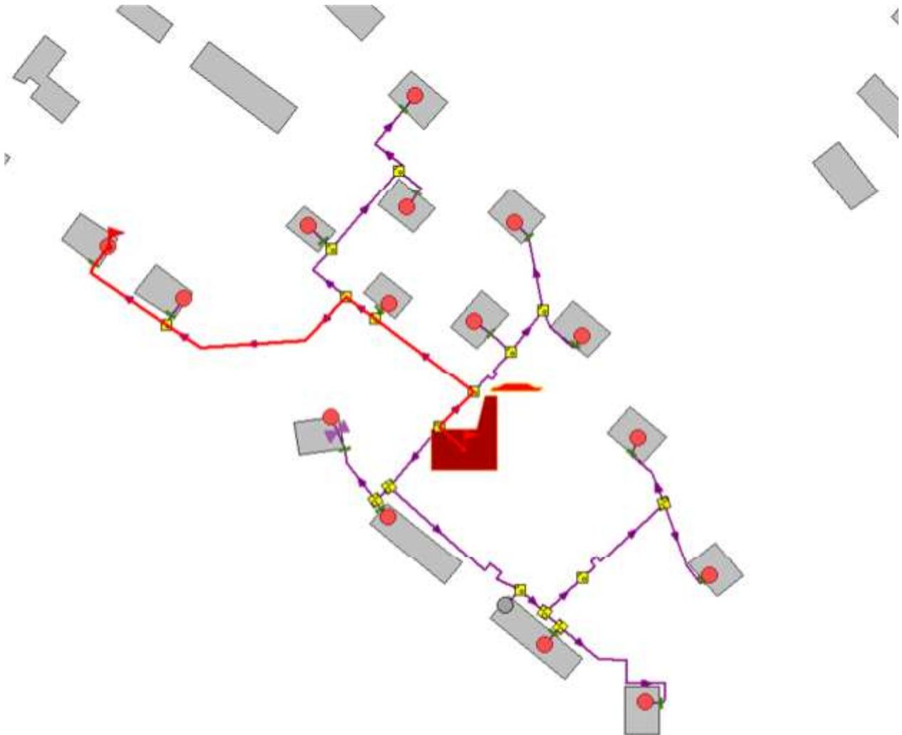
**Рисунок 6.1 -Расчетный путь теплоносителя котельной до Дрейера, 15 к.3**
