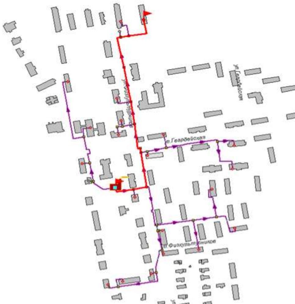
**Рисунок 28.1 -Расчетный путь теплоносителя от котельной до Петрова,9**
