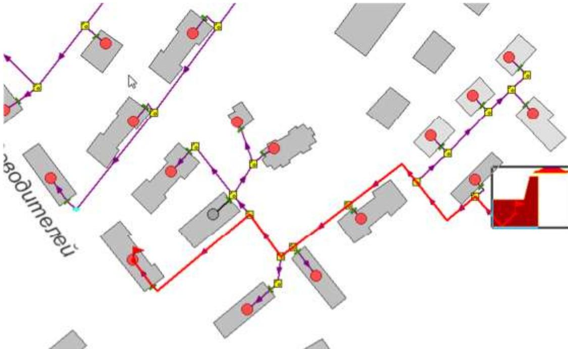
**Рисунок 17.1 -Расчетный путь теплоносителя котельной до Речников,29**
