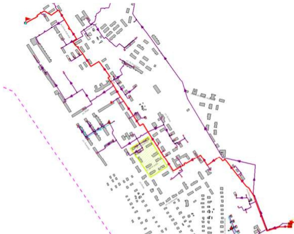
**Рисунок 2.3 -Расчетный путь теплоносителя от Цигломенской ТЭС до Лочехина, д.13**
