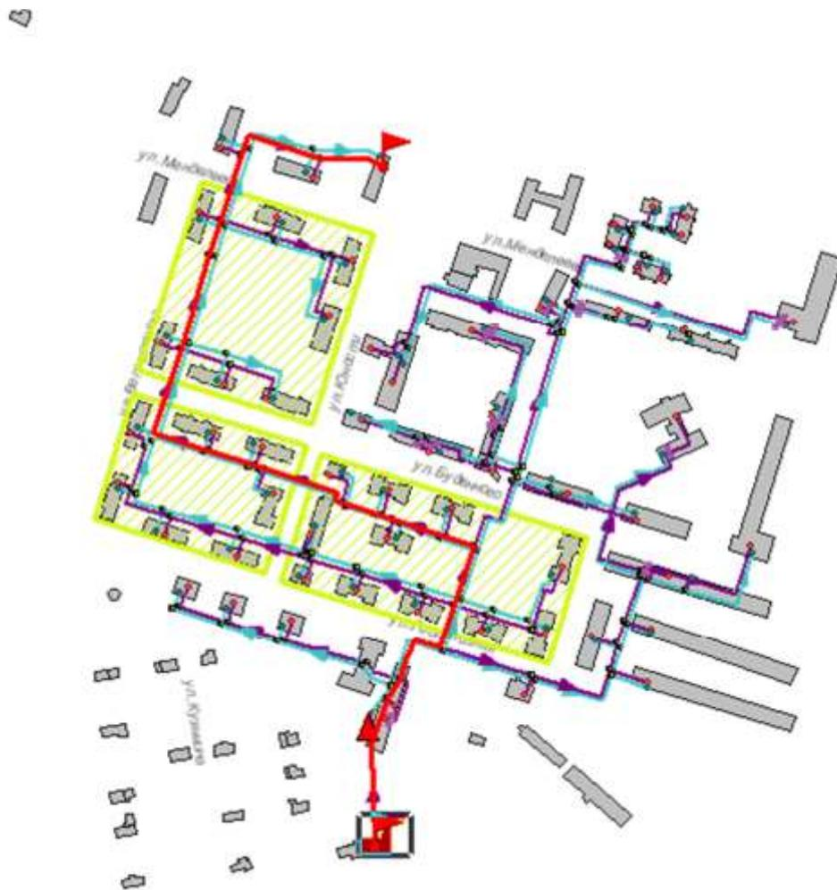
**Рисунок 31.1 -Расчетный путь теплоносителя от котельной до Юности,2**
