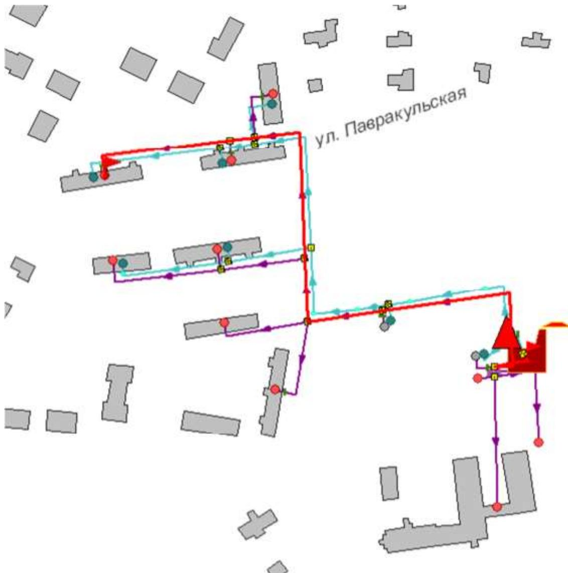
**Рисунок 32.1 -Расчетный путь теплоносителя котельной до Победы,12,к.2**
