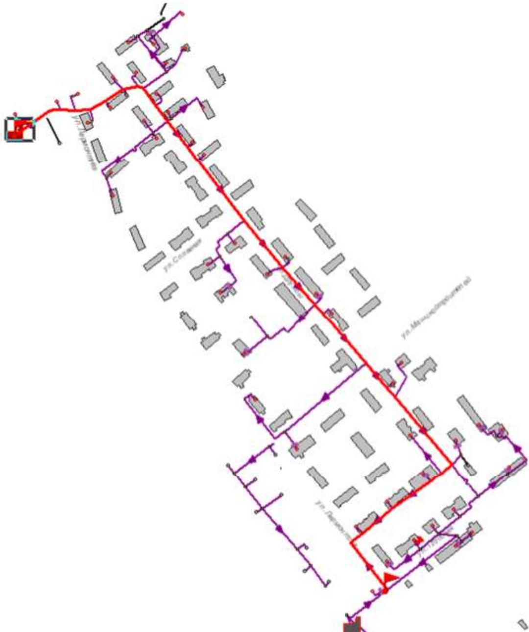
**Рисунок 13.1 -Расчетный путь теплоносителя котельной до Лермонтова 23, стр.20**
