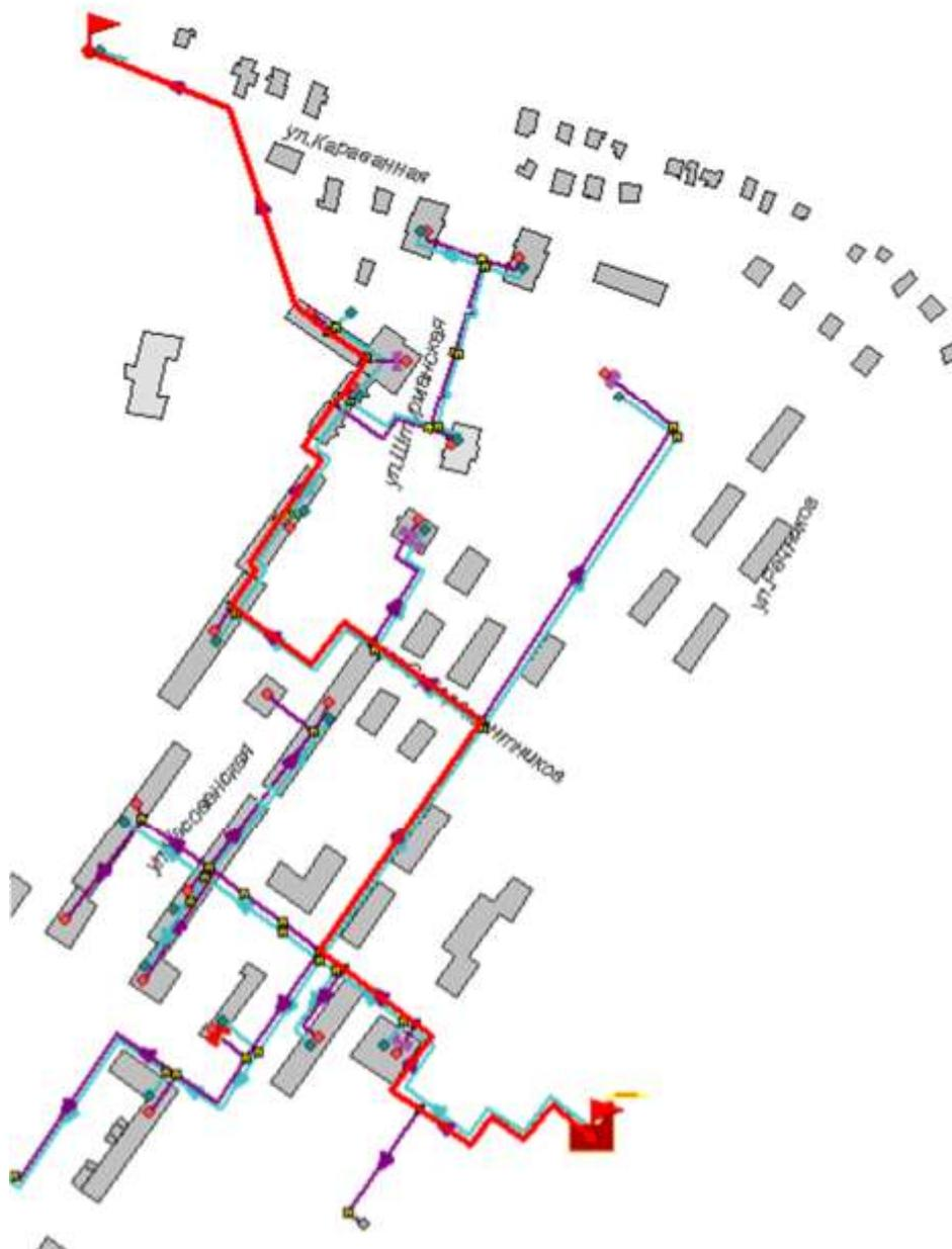
**Рисунок 15.3 -Расчетный путь теплоносителя от котельной до очистных сооружений**
