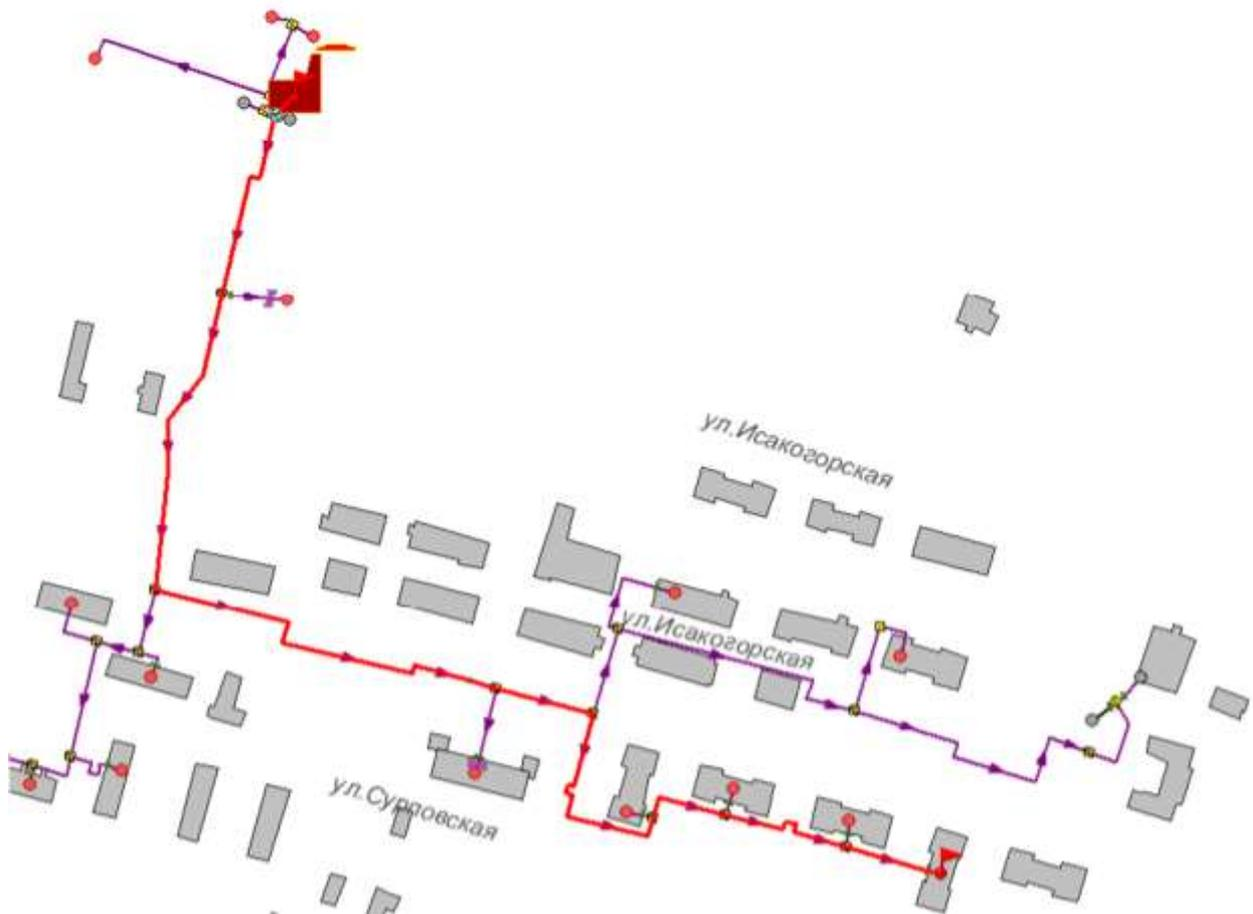
**Рисунок 5.1 -Расчетный путь теплоносителя котельной до Сурповской, 20**
